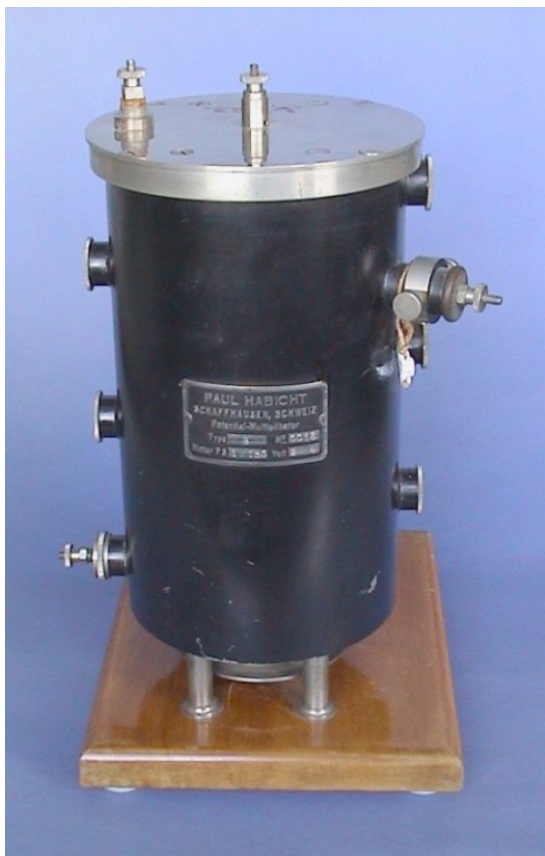
Slika 3 - "mašinica", odnosno instrument za merenje malih električnih napona
